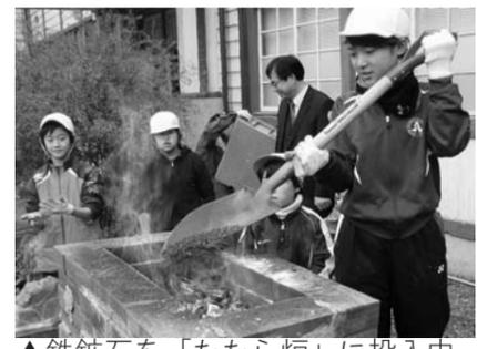
▲鉄鉱石を「たたら炉」に投入中
