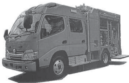
△ 最新水槽付消防ポンプ
